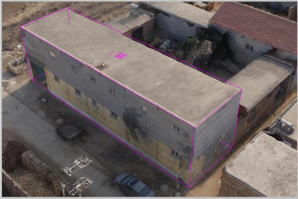
图 6 - 5 基于墙面绘制房屋
