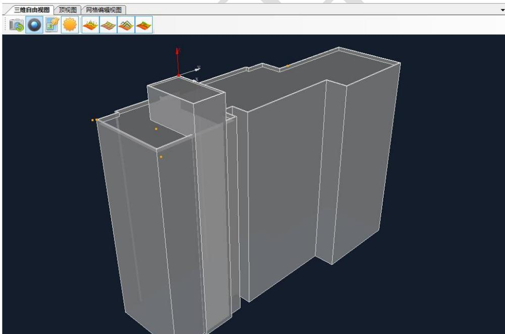
13、对阳台结构的制作。将基准点定位到阳台所在的基准面上，参照（4）（5）的步骤对阳台进行轮廓的勾勒。（对阳台的勾勒，由于它的轮廓线部分与建筑物柱体结构是重合的，因此可以将轮廓线画过一些，在后续对其调整）。
