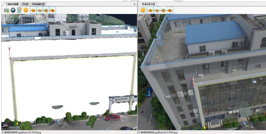
12、根据影像，利用推拉工具将相应的结构向内推拉，形成凹凸明显的结构。
