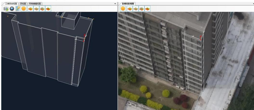
16、得到的模型中，阳台柱体与建筑物柱体会有重叠的面，选择重面，删掉其一。具体做法：将阳台柱体对其进行体孤立，选择重面删除。注意删完后取消孤立。
