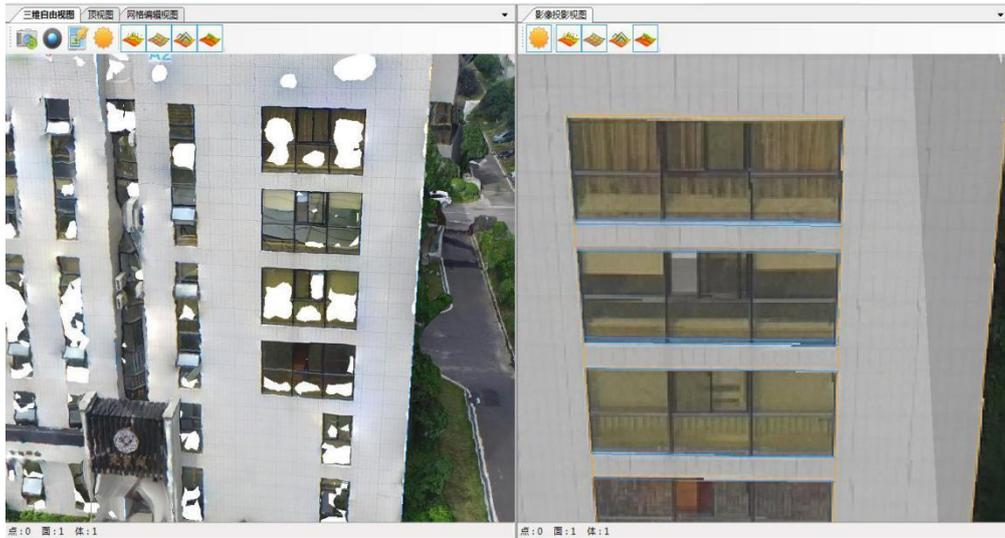
11、建筑物正面结构的制作。建筑物的正面是一个凹凸比较多且明显的结构，利用切割工具根据影像在这个面上切割出相应的形状（也可以根据 OSG 模型切割出相应的形状，但是需要将切割的线根据影像将其调节成与影像吻合）。
