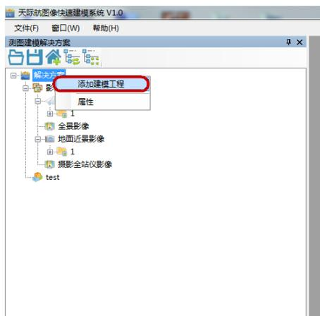
(2) 按一下功能表中的“添加建模工程”，系统弹出新建建模工程视窗。
