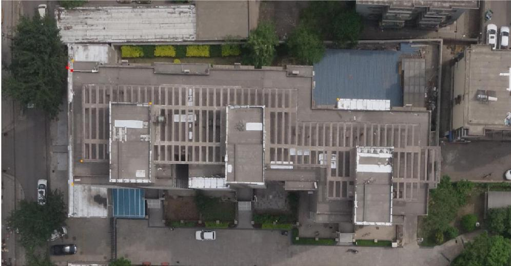
5、选择多边形绘制工具，根据选择的影像画出建筑物的轮廓线。
