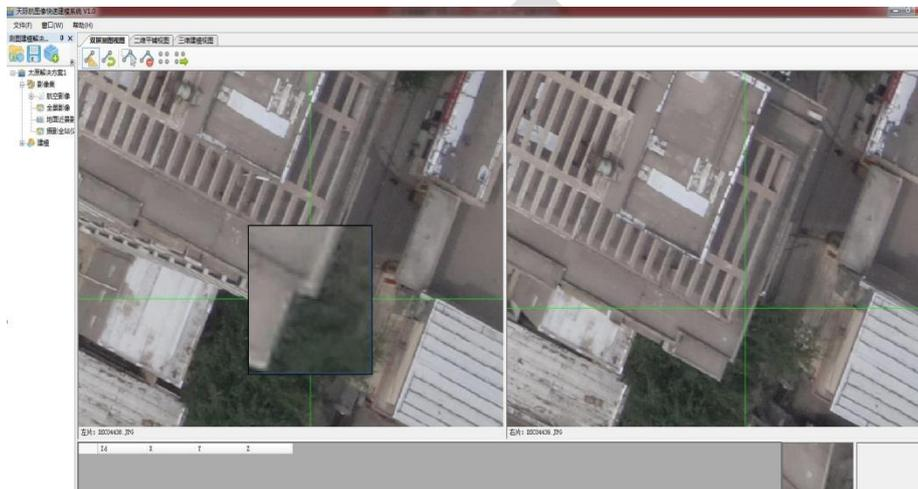
(3) 按照 (2) 的方法，在双屏测图视图中的右侧视窗获取相应的测量点。按下空格得到该点的坐标值。
