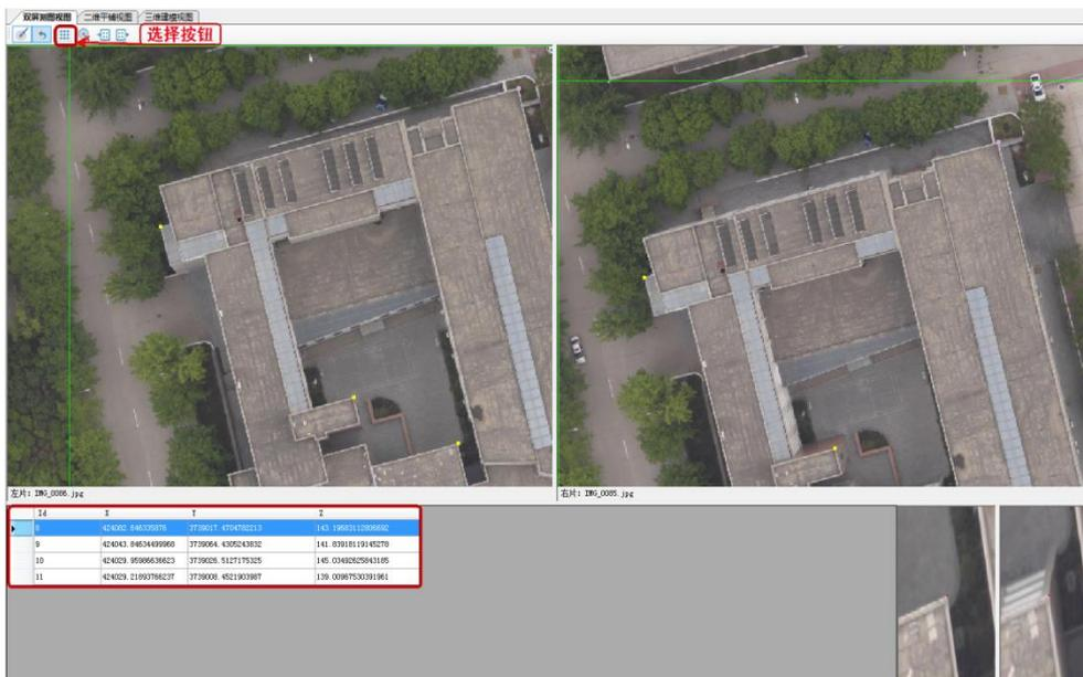
(3) 这时可以看到选中的测量点由黄色变成红色，双屏测图视图上方“删除”按钮，即完成测量点的删除。
