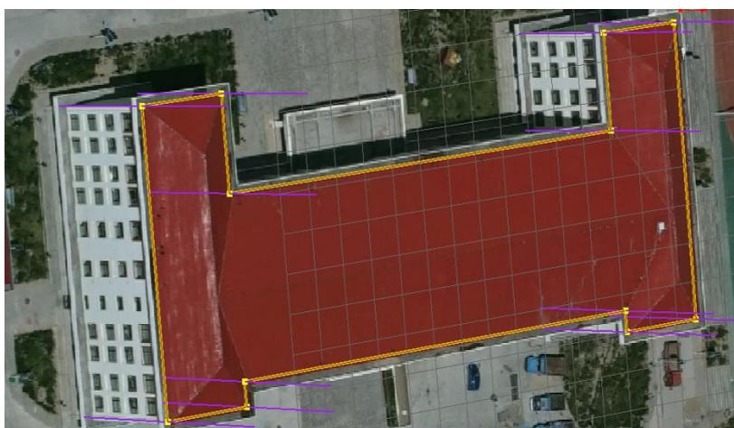
(3) 局部调整矢量线，选择没有对齐的线，使用编辑多面体工具 ‘
