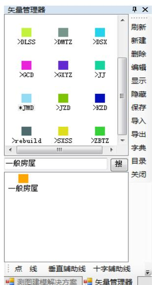
(2) 用矢量测图图层管理器中“线”工具（快捷键 **ctrl+g**）。依据线状物的外轮廓边缘提取二维矢量。
