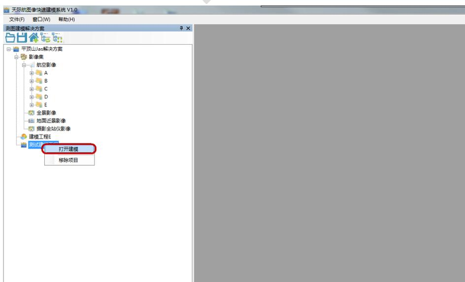
(5) 点击功能表中的“打开建模”，进入模型编辑状态，系统自动打开多个视图，包括二维平铺视图、双屏测图视图、三维建模视图。
