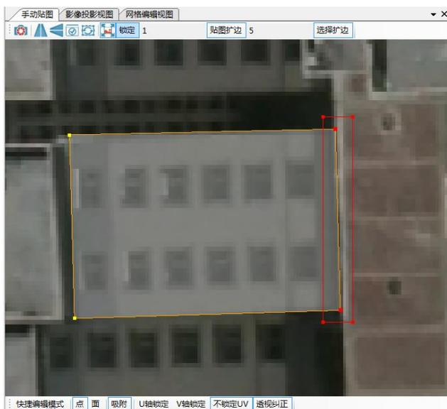
(4) 如果所有能覆盖该面的影像，都存在遮挡等问题，这时选择一个贴图，点击“使用预设工具打开影像
