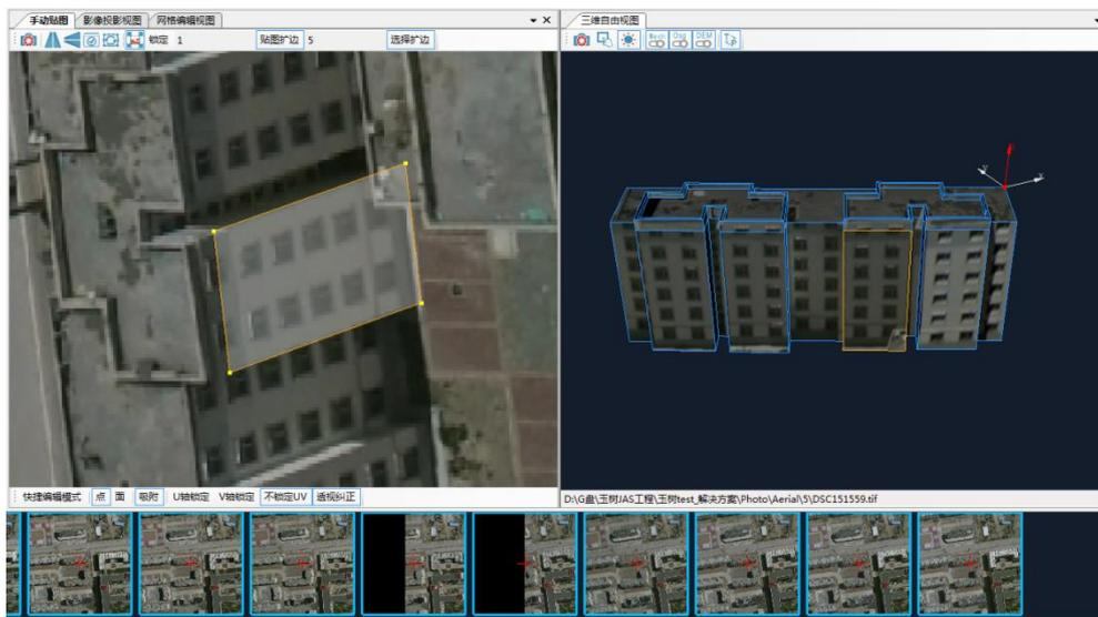
(2) 选择能完成覆盖该面的倾斜影像，按“T”，可实现用当前选择影像完成贴图的替换。
