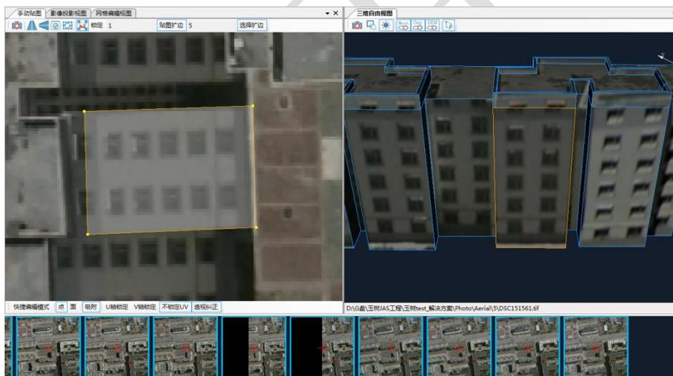
(3) 可手工调整 UV 编辑方块，编辑方块提供点、线、面编辑、U 轴/V 轴锁定、透视纠正等功能，根据影像调整好编辑方块后，重新按“T”替换影像。
