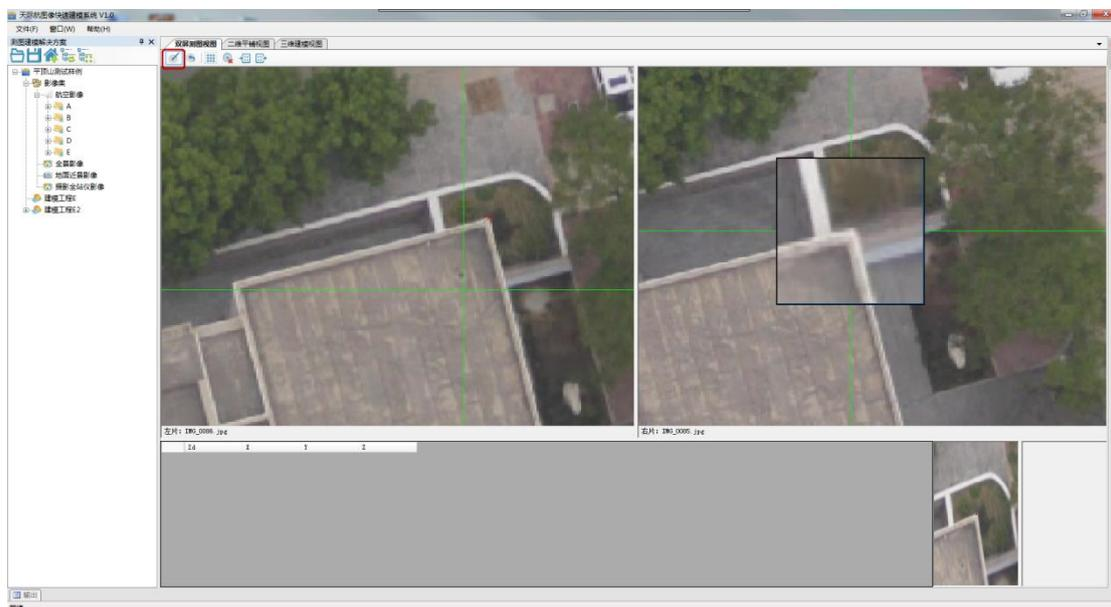
(3) 在局部影像放大视窗中，点击鼠标左键测量定位的测量点，可以在双屏测图视图左侧视窗中看到测量的标记点。
