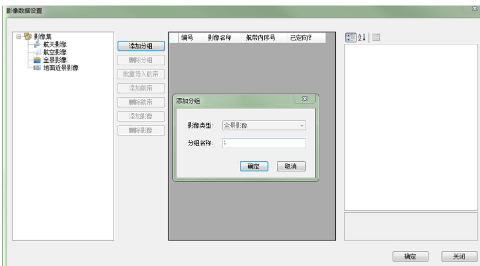
(3) 点击“批量导入航带”，在弹出的窗口中，选择事先准备好的三个航带档：影像列表、相机内参数、外方位元素。
