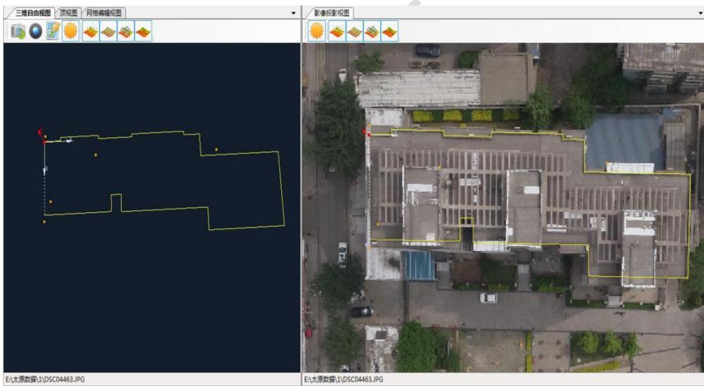
6、建筑物柱体的创建。此时选择一张建筑物的侧面图，能够观察到建筑物的顶和底的影像。
