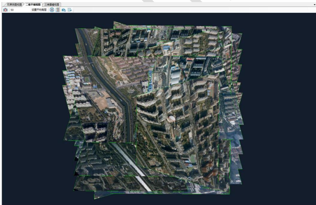
点击“垂直筛选”
