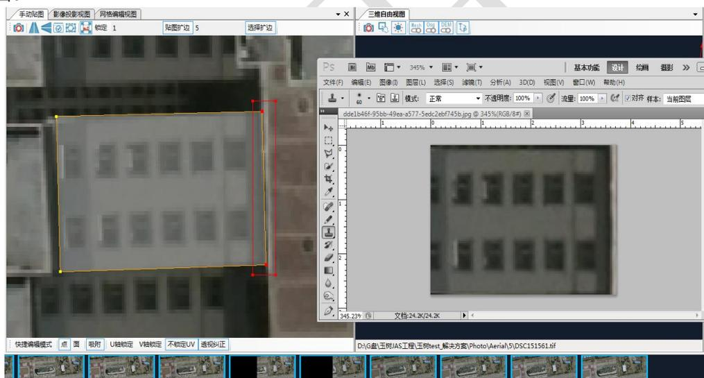
(5) 关联 PS 编辑纹理去掉色差或遮挡后，保存贴图，点击“重载贴图
