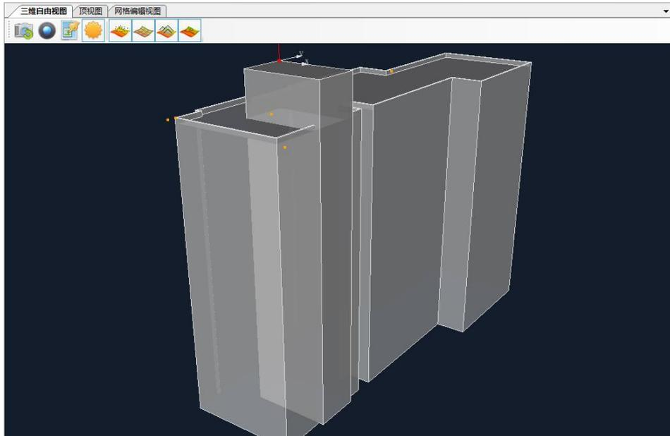
10、对交叉结构的修改编辑。由于该突出结构延伸至地面，与建筑物本身柱体结构会发生交叉，因此需要对交叉的结构进行修改。选择该突出结构，右键对其进行“体”孤立。选择切割工具，在交叉的面上切割出两交叉结构交线的形状。
