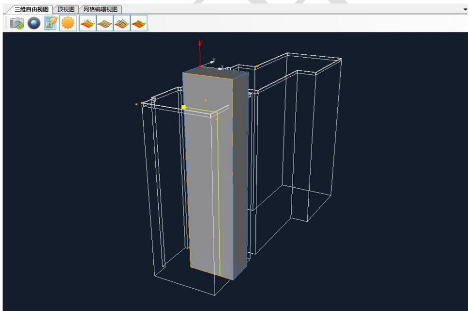
11、选择交叉的面，删掉。选择切割的线对其进行平移使其正好吸附在交叉的线处。具体操作：选择其中一条切割的线，利用编辑多面体工具，进行点的平移操作（需要将该条线往哪个轴平移，就用鼠标左键在该轴上按两下，使该轴成为黄色；右键按住需要平移的线的一个端点移动使其吸附到该条正确的位置）。
