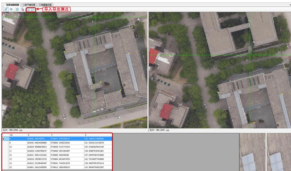
(2) 点击“汇出测点”
