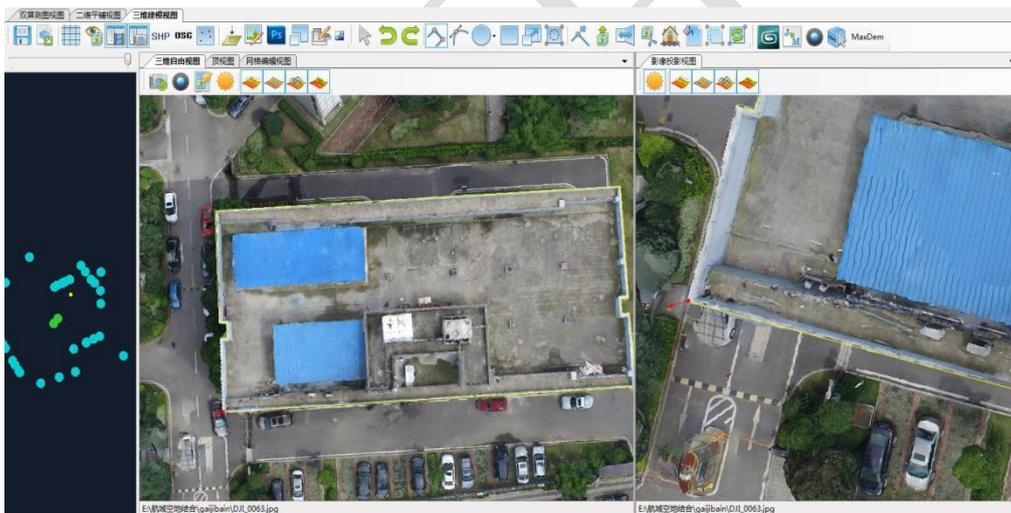
6、由于 OSG 模型只是一个参考，而最后的模型还是以影像为准，因此画的房屋轮廓可以进行适当调整让其与影像吻合（具体实现：选择需要调节的线的两 endpoint，需要将该条线往哪个轴平移，就用鼠标左键在该轴上按两下，使该轴成为黄色；右键按住需要平移的线的一个 endpoint 移动使其移动到该条线正确的位置）。
