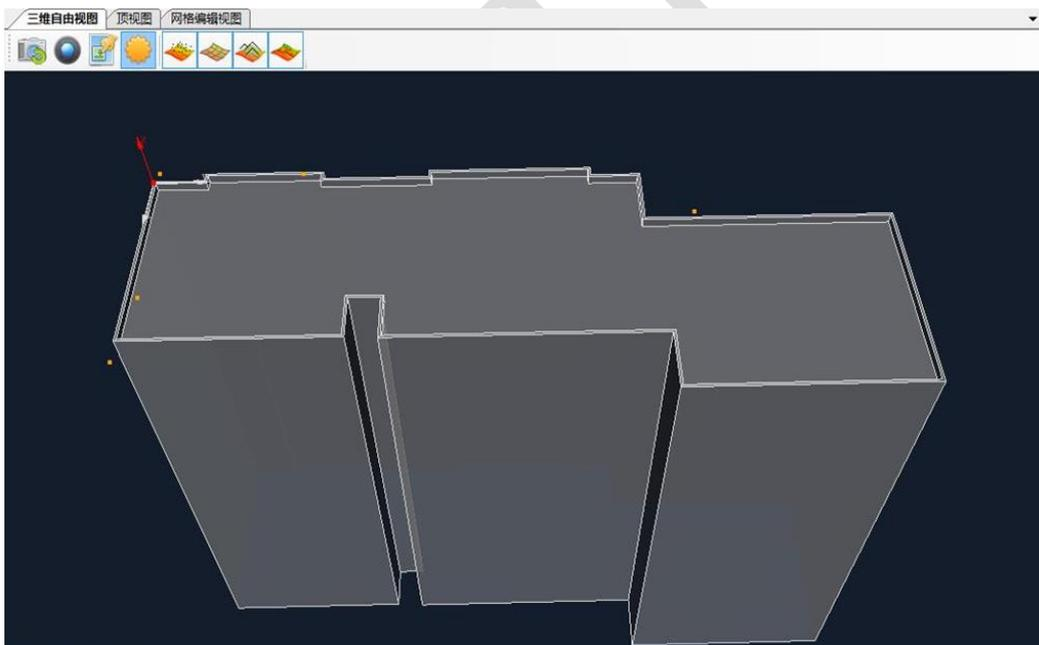
8、建筑物附属结构的制作。将基准点定到需要建模的结构所在的基准面上（如这里对屋顶上突出结构的制作）。
