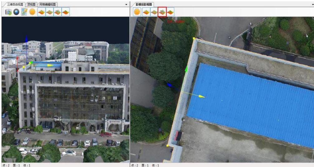
7、将基准点定位到地面上，把上一步勾勒的房屋轮廓推拉至基准点上，形成建筑物的柱体结构。
