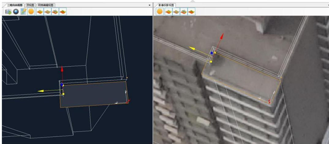
15、将编辑、调整好的阳台轮廓线，依据影像将其推拉至合适的位置，得到该阳台的柱体。其他阳台的制作与此类似。
