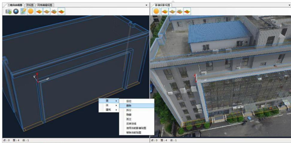
14、建筑物正面的窗户的制作参照（9）（10）；其他凹凸的结构参照（11）（12）（13）。得到最后的模型。
