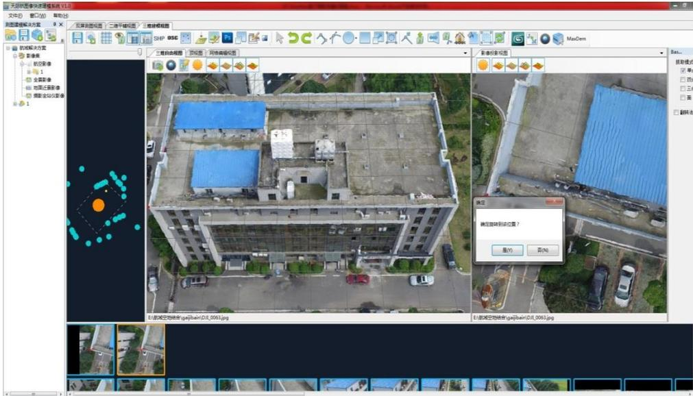
5、房屋轮廓的勾勒。将基准点定位在房屋屋顶的角点上，根据 OSG 模型进行房屋轮廓的勾勒（生成的 OSG 模型是立体模型，因此在勾勒房屋轮廓的时候，尽量将模型旋转成俯视图模式，便于勾勒）。
