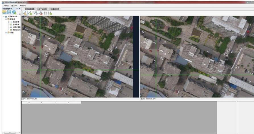
(2) 在双屏测图视图中，选择左侧视窗，通过鼠标滑轮缩放影像大小、调整清晰度，选择需要几何建模的建筑物，在其轮廓边缘大致确定测量点位置。这时我们点击鼠标左键，出现局部影像放大视窗。在放大视窗中点击一下需要测量的点。
