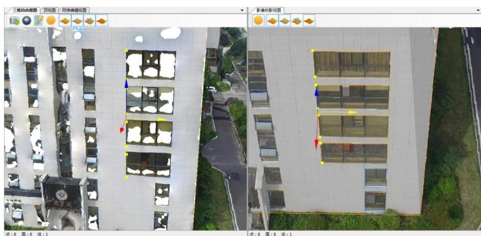
11、根据影像，利用推拉工具将窗户向内推拉出一定的厚度。
