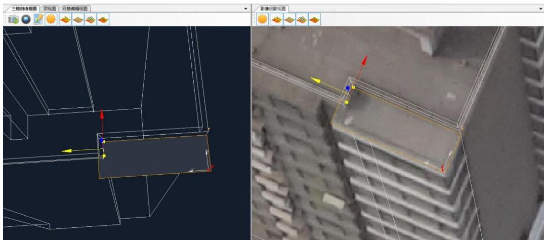
15、将编辑、调整好的阳台轮廓线，依据影像将其推拉至合适的位置，得到该阳台的柱体。
