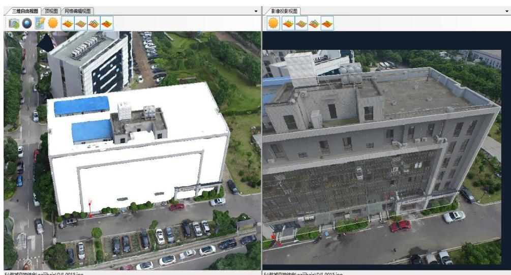
8、女儿墙的制作。将基准点定位到房屋屋顶的角点上，根据影像，利用内偏移工具将屋顶向内偏移出一个等距的多边形。
