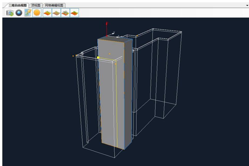
11、选择交叉的面，删掉。选择切割的线对其进行平移使其正好吸附在交叉的线处。具体操作：选择其中一条切割的线，利用编辑多面体工具，进行点的平移操作（需要将该条线往哪个轴平移，就用鼠标左键在该轴上双击，使该轴成为黄色；右键按住需要平移的线的一个端点移动使其吸附到该条正确的位置）。
