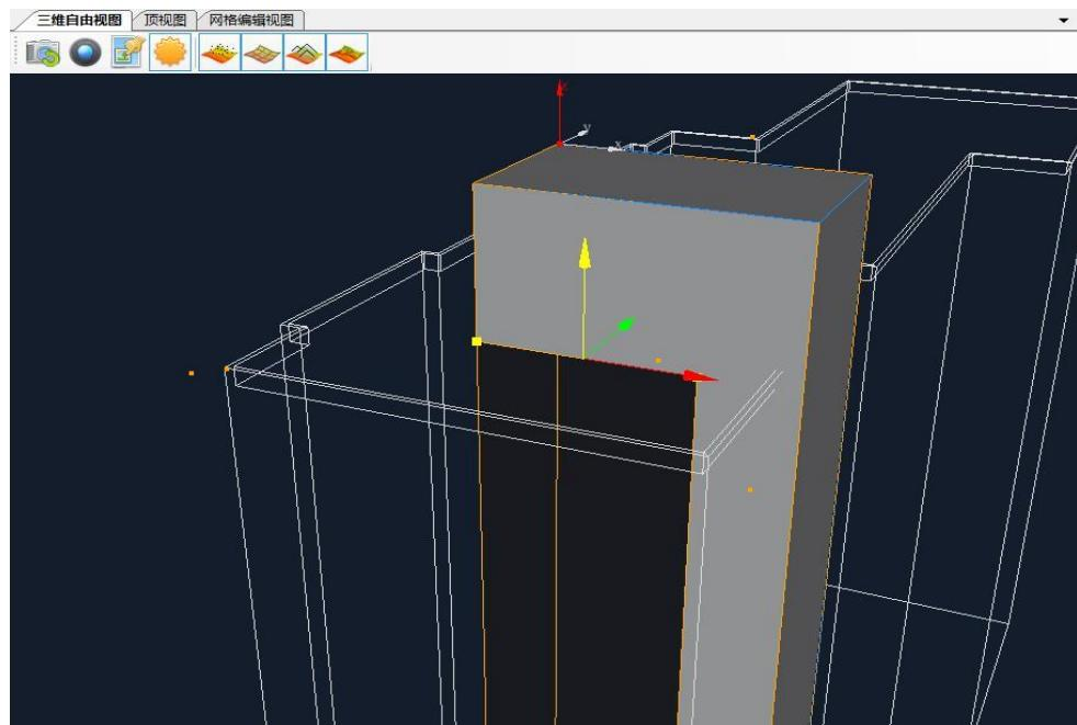
12、对另一条切割线的操作和该突出结构的其他两个交叉面的处理过程参照(11)，对该体处理完后注意右键，对建筑取消孤立。其他两个突出结构亦采取相同的制作方法。
