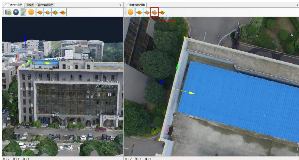
7、将基准点定位到地面上，把上一步勾勒的房屋轮廓推拉至基准点上，形成建筑物的柱体结构。
