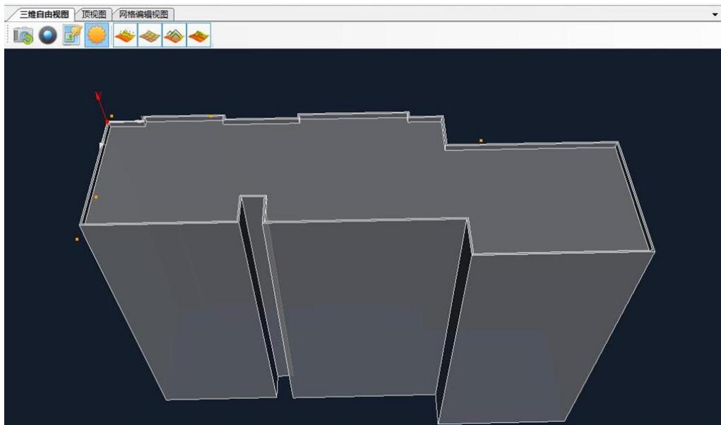
7、对建筑物顶部女儿墙的制作。回到上述的俯视图，选择内偏移工具，根据影像，向内偏移出一个等距的多边形，并对其进行推拉，得到女儿墙的结构。
