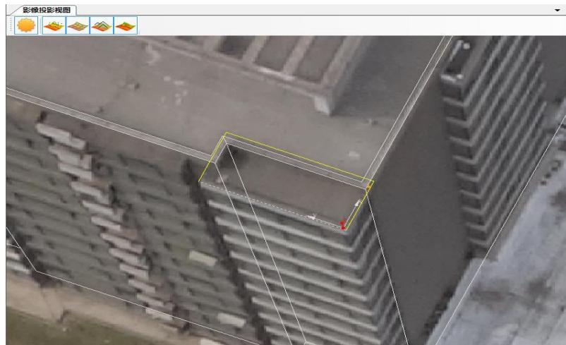
14、选择阳台轮廓线所在的面，右键对其进行面孤立。参照（11）的方法，根据影像对其进行编辑、调整。调整完后注意需要将建筑取消孤立。
