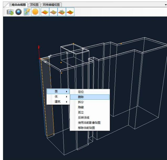
17、对建筑物顶部支架的建模。将基准点定位到建筑物顶部支架所在的基准面上，参照画房屋、阳台轮廓的方法对其勾勒其整体轮廓，根据影像和支架的结构，利用切割工具，有支架的地方进行保留，其余部分则删掉，最后对其进行适当推拉。得到最终的模型。
