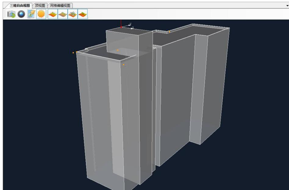
10、对交叉结构的修改编辑。由于该突出结构延伸至地面，与建筑物本身柱体结构会发生交叉，因此需要对交叉的结构进行修改。选择该突出结构，右键对其进行“体”孤立。选择切割工具，在交叉的面上切割出两交叉结构交线的形状。
