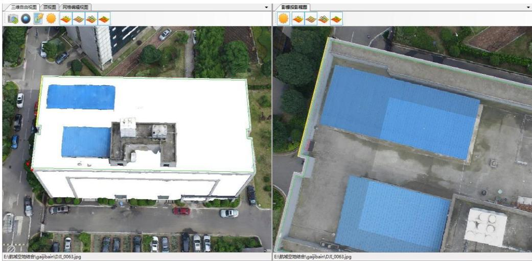
9、根据影像，将向内偏移的多边形推拉出一个柱体，形成女儿墙的结构。
