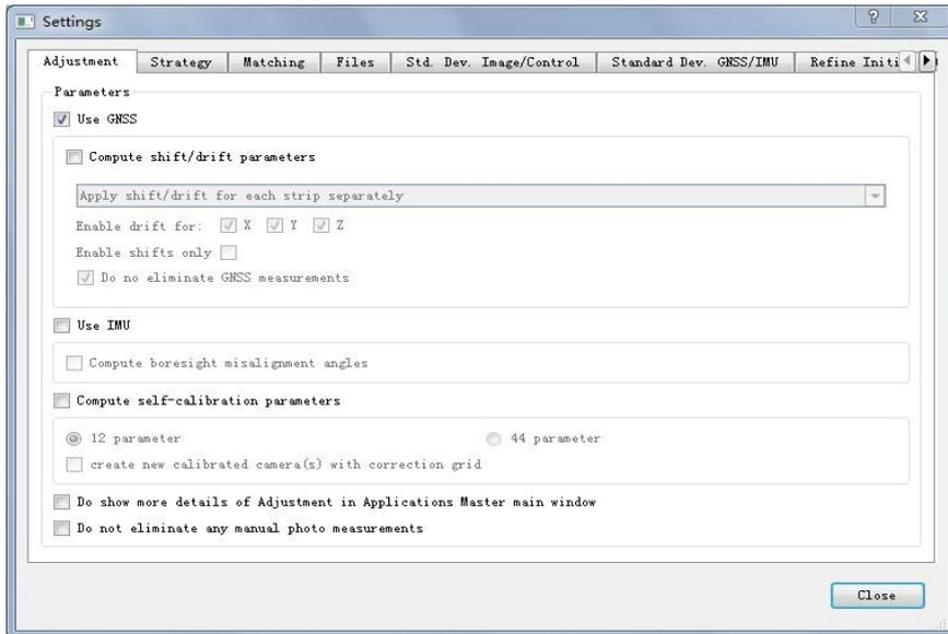
一般 GNSS 的精度在 0.05-0.3m 之间，利用 GNSS 可以在保证精度的同时减少控制点数量。
