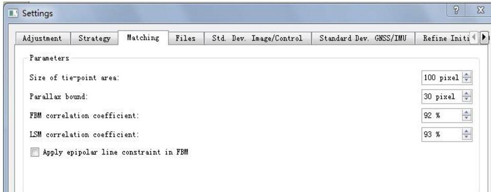
匹配点区域大小：定义特征级匹配的连接点区域大小，值的设置从 400 像素到 100 像素，值越大，会提取越多的点。较小的值会增加计算速度。
