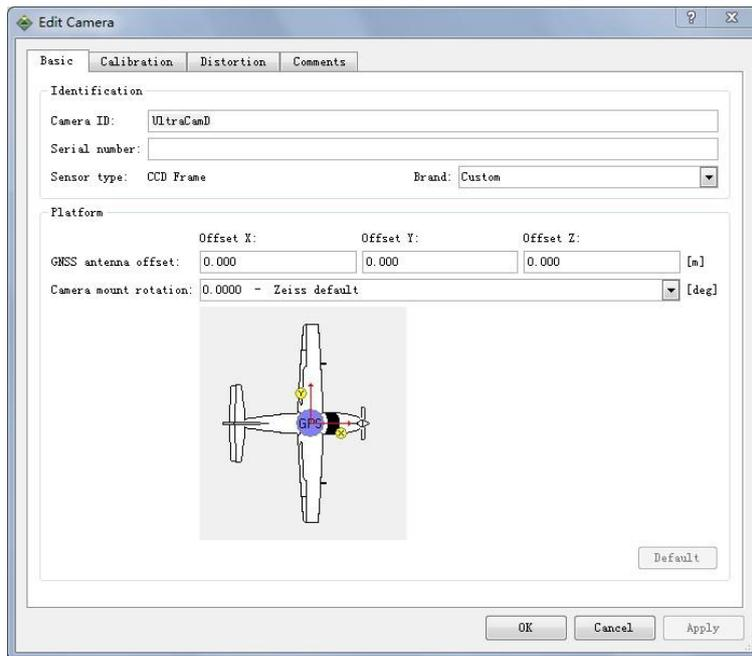
相机的旋转角度为图像坐标的 x 轴方向和飞机飞行方向间的夹角。Zeiss 相机通常是 x 轴和飞行方向一样，而徕卡相机需要旋转 180 度。例子中，OFFINGEN 相机输入 0 度。
