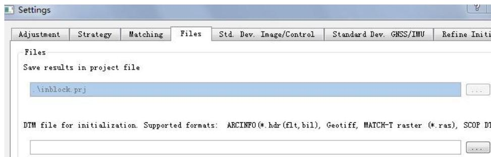
主要用来加载用于初始化的 DTM 文件，DTM 文件一般为 Inpho 格式或者 XYZ 格式。这部分主要适用于地形起伏较大的地区。
