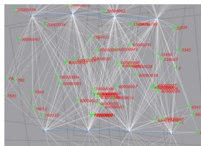
**Jointsectorspoints:** 每个连接点在各方向上被分为六个部分，如果在这个像片的范围内，在某个方向上无重叠区，则这个方向上显示为红色；如果在这个像片的范围内，在某个方向上为一度重叠，则这个方向上显示为黄色；如果超过一度重叠，则这个方向上显示为绿色。
