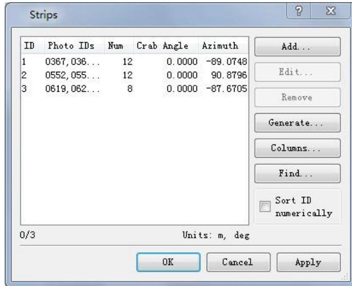
如果航带需要手工编辑，则点击添加或者编辑按钮，输入航带 ID。设置偏移角更正，这个偏移角更正式飞行方向轴和航带方向之间的偏差，这里设置为 0。
