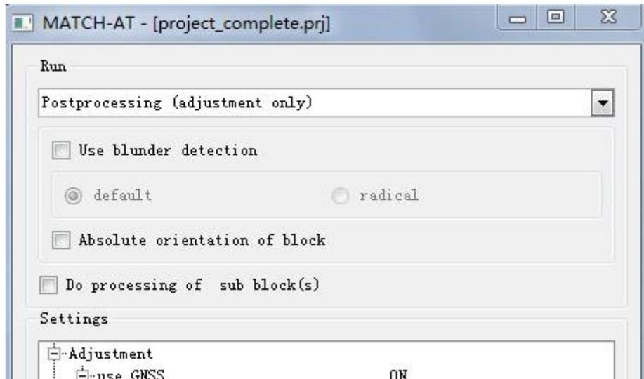
如果勾选粗差检测，则对于不符合的自动提取的连接点进行剔除。因此如果你没有足够的量测控制点，建议不要选择粗差检测。
