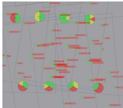
**Jointlinespoints:** 该连接点与包含该点像片中心的连接线。
