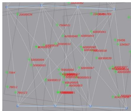
**jointsectorsphotos:** 每个像片的中心点在各方向上被分为六个部分，如果在这个像片的范围内，在某个方向上无重叠区，则这个方向上显示为红色；果在这个像片的范围内，在某个方向上为一度重叠，则这个方向上显示为黄色；如果超过一度重叠，则这个方向上显示为绿色。
