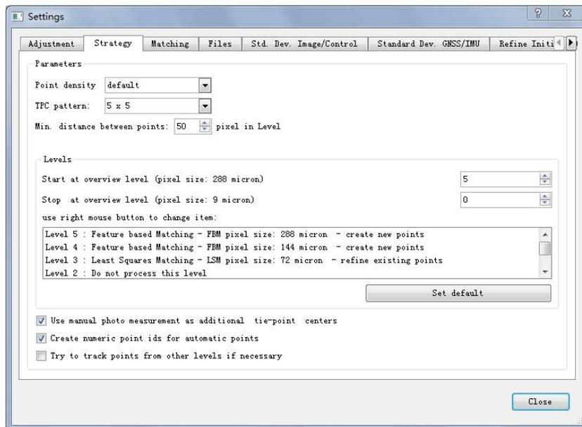
点密度：默认则通常能保证每张像片 100-200 个点；Dense 或者 Extreme 的方式能提取更多的点，通常适用于纹理缺少地区（沙漠）；sparse 适用于重叠度超过 80% 的区域。
