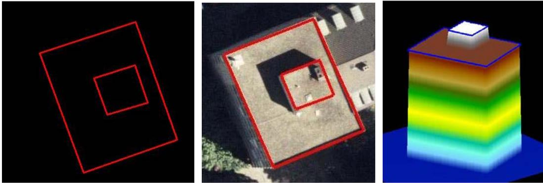
附加的闭合多边形模拟了屋顶或院子里的圆柱。内部多边形的高度决定了是院子里的还是屋顶上的物体。模拟院子需要把地面的高程给最高点。可能有更多的闭合多边形组合在一起。组合的最高限制是8个这样的闭合多边形。
