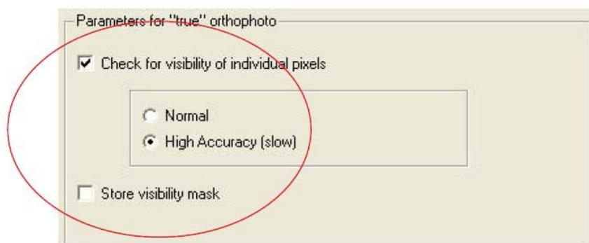
注意：对每个正射影像的像元检查，它是否在影像中可视，或者在不包括区，例如DTM中建筑物的隐藏区。不可视像元用彩色来标记。为了得到建筑物和桥的平滑的边界，需要选择High Accuracy高精度。这样软件就需要较平常4倍的时间来计算子像元可视标记区。
