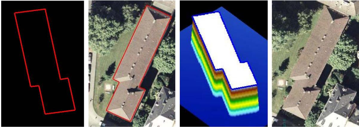
用简单的方法获取建筑物。用对象最外的边界和最大的高程获取多边形。最后的图像显示真正射影像。
