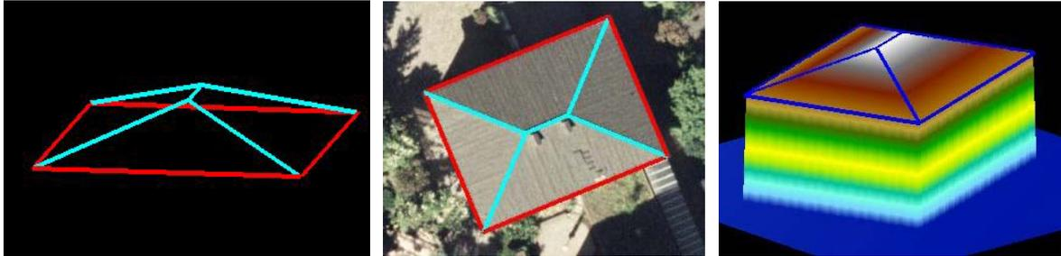
附加的线模拟所有的屋脊，结果较好，现在精确模拟了所有的屋脊。
