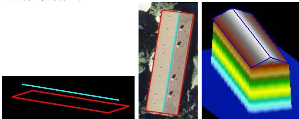
闭合的多边形模拟了建筑物的檐槽。开放的线模拟了屋脊。开放的线用二维的粘贴到闭合的线中。
