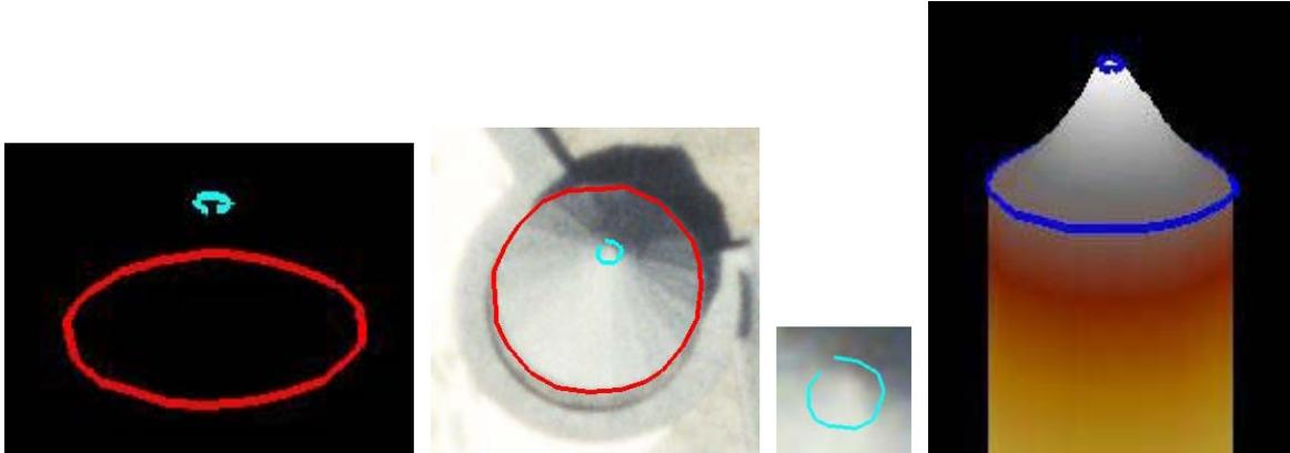
带有圆锥形的屋顶可以用一个小的开放的多边形来模拟圆锥的顶。开放多边形的空隙至少应为0.01m，以免自动闭合多边形。
