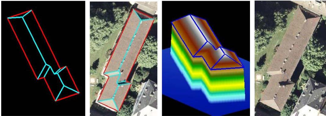
例子显示具有不同的闭合的和开放的多边形的相同建筑物。最后一个图像显示了处理后的真正射影像。可以看出，两幅真正射影像之间没有区别。
