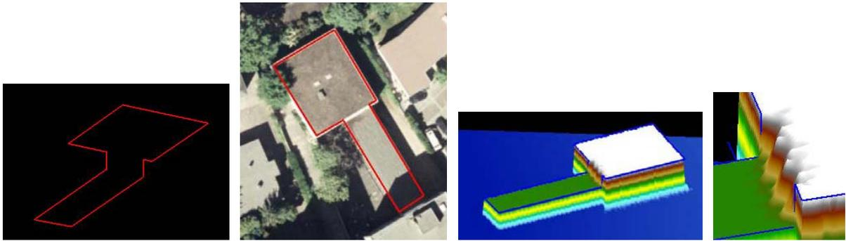
这个例子显示了如果使用这种方法来量测一个物体，建筑物的角就会出现凹口。因此不建议用这种方法来量测建筑物。
