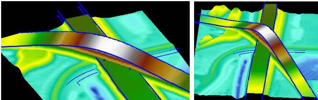
注意：两个对象模型不一定非要相交。位于上部的桥用闭合的多边形表示，而桥则被分成两个独立的封闭多边形。这些闭合的多边形连接在一起。街道由折线量测，可能穿过桥。
