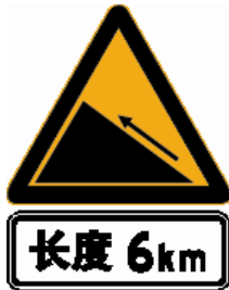
a) 长陡上坡警告标志
