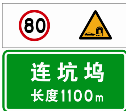
长度超过 500 m 的隧道预告标志示例
