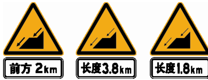
长坡陡下坡标志示例
