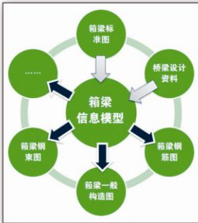
箱梁信息模型将所有设计工作集中在模型中, 保证设计各阶段数据一致。
