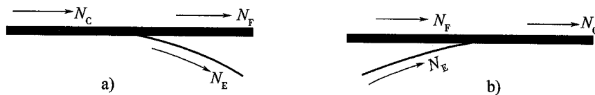
图 11.4.2 分、汇流处的车道数平衡 a)分流;b)汇流
