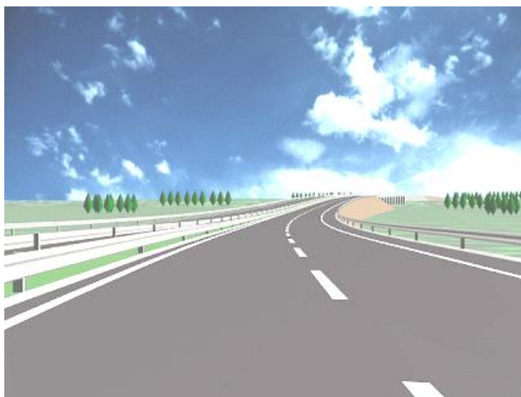
图 19-2 利用 HintVR 纬地三维道路实时漫游系统制作的公路路线全景透视图
